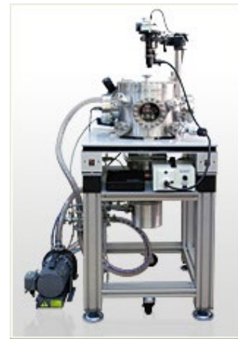
Рис.2 Высоковакуумная система СОЛБЕР HV-MFM ( 10^{-8} Торр)
