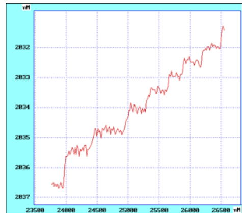
Ступенчатая поверхность базовой плоскости сапфира (c-plane) и ее сечение указанной плоскостью. Ступенчатая поверхность получена при отжиге образца при температуре 1350 °C.
